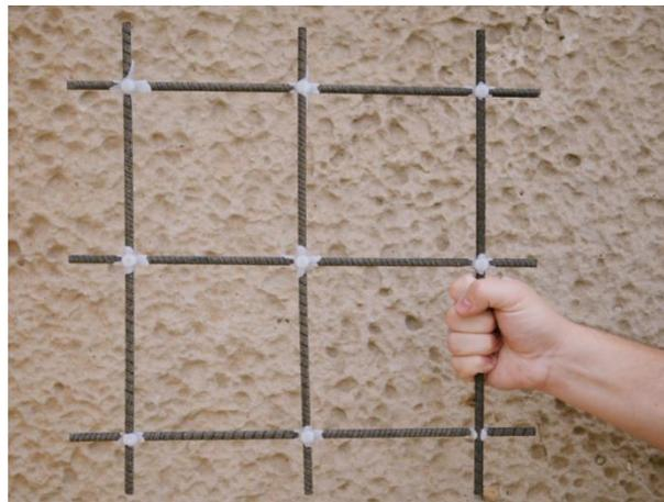
Сетка предназначена для армирования бетона взамен традиционной металлической арматуры. Обладает значительными преимуществами по сравнению с металлом:
